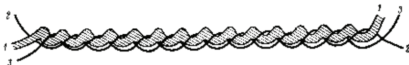
Fig.3.7. Tjerrja efektive mulin me pamje valore
